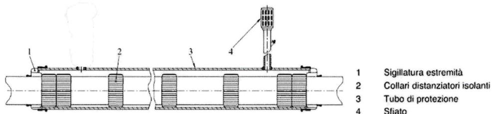
L'intercapedine, per lunghezze del tubo di protezione inferiore a 30 m, deve essere comunicante con l'ambiente esterno tramite n° 1 sfiato di diametro non inferiore a 30 mm.
